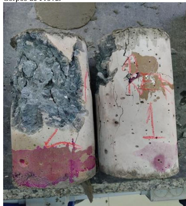
Figura 6: Reação com o Indicador Fenolftaleína nos Corpos de Prova.
