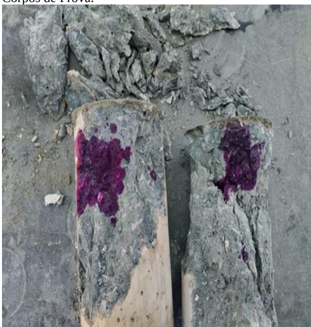
Figura 5: Reação com o Indicador Fenolftaleína nos Corpos de Prova.
