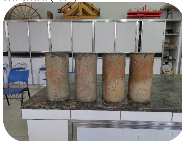
Figura 1: Corpos de prova 1: (a) Referência (REF). b) Soda Cáustica (NaOH)
