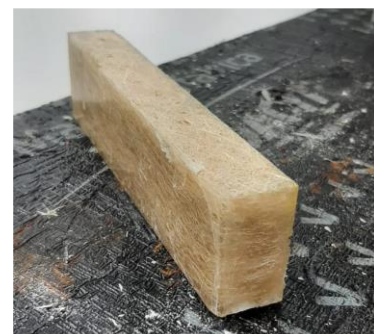
Figura 7 - Compósito após a cura e desmoldado.
