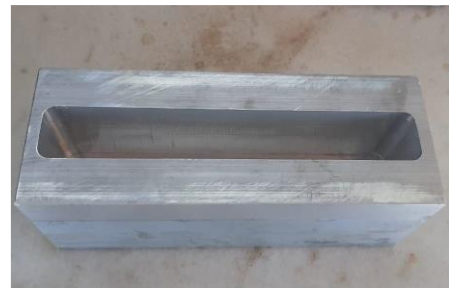
Figura 4 - Molde em alumínio 7075.
