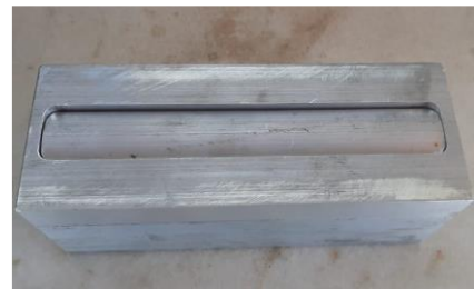
Figura 5 - Molde e Tampa em Alumínio 7075.
