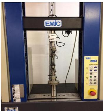
**Figura 2-** Máquina de ensaio de tração universal modelo EMIC (UNIFEI).
