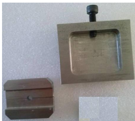
Figura 4- Imagem do molde preparado em aço inox 304L, para confecção dos corpos de prova para ensaio de compressão. Fonte: da SILVA, 2015
