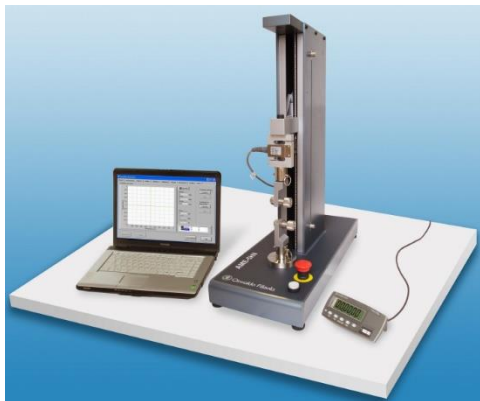
Figura 6 - Equipamento de Teste Universal AME 5kN (Oswaldo Filizola®).
