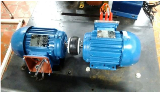
Figura 5: Acoplamento das máquinas primária e GIGE- Fonte: O autor
