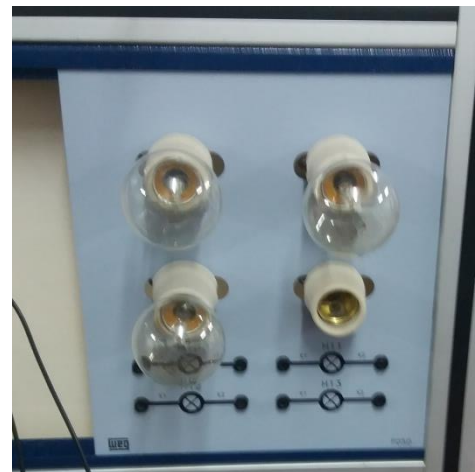
Figura 7: Módulo que simula o comportamento da carga - Fonte: O autor
