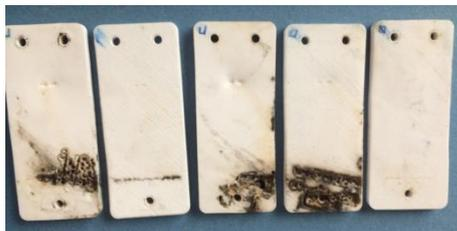
**Figura 15:** Amostra de PLA após o ensaio de trilhamento elétrico.
