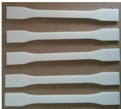
**Figura 10-** Corpo de prova de Tração em ABS.
