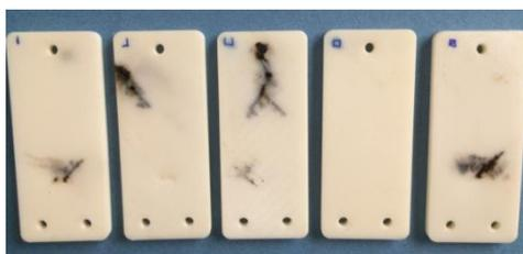
**Figura 17**- Amostra de ABS após o ensaio de trilhamento elétrico.
