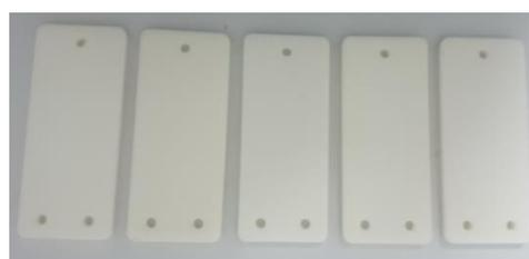
**Figura 8** - Corpo de prova de trilhamento Elétrico em ABS.
