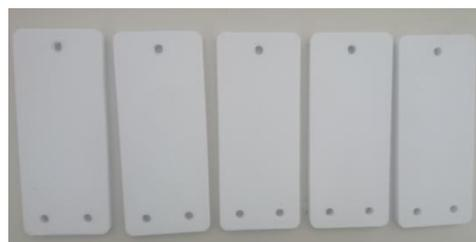
**Figura 7-** Corpos de prova de trilhamento Elétrico em PLA.
