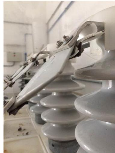
**Figura 4-** Ensaio de trilhamento Elétrico segundo a norma 10296.
