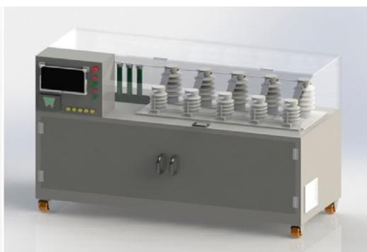
**Figura 6** – Bancada de ensaio de trilhamento elétrico
