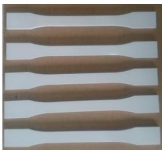
**Figura 9-** Corpo de prova de tração em PLA.
