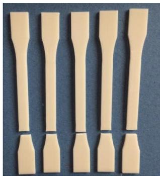
**Figura 13-** Amostras de ABS após ensaio de tração
