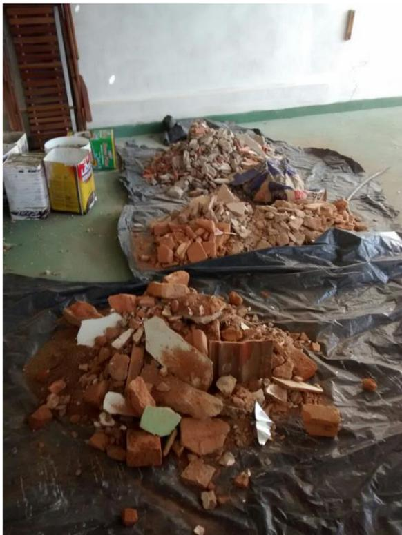
Figura 01- Amostras coletadas de RCC
