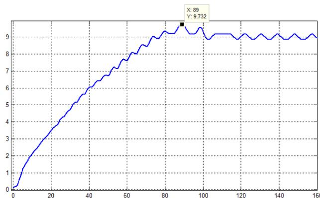
Figura 7 – Resposta ao degrau do sistema controlado
