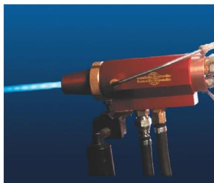
**Figura 11. Desenho esquemático do processo High velocity Oxi-Fluel Spraying. Fonte: Brito (2010).**
