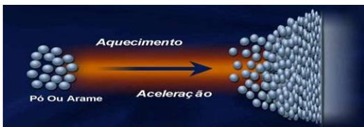
**Figura 3.** Desenho esquemático do processo de aspersão térmica. Fonte: Allbiz - Revestimento por Aspersão Térmica, Pinhais.
