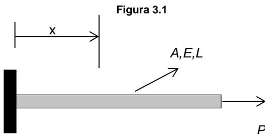
Utilizando o processo de discretização do meio contínuo por elementos finitos, a barra será modelada, como na figura 3.2.
