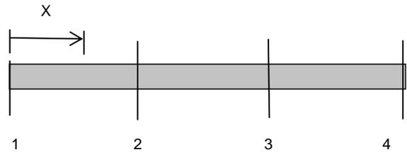
Cada elemento de barra coincide com eixo  $x$  e possuem dois nós que são pontos extremos dos elementos. Considera-se que cada nó possui um grau de liberdade que é o deslocamento do nó na direção do eixo  $x$ , ou seja, deslocamentos  $u_1$  e  $u_2$ . A Figura 3.3 a seguir a discretização do primeiro elemento. (de Oliveira, 2015).
